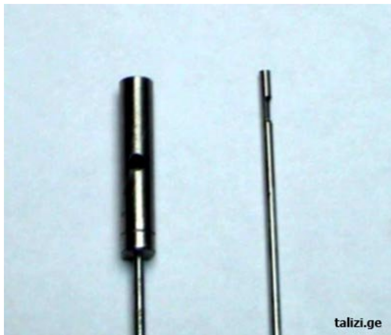
Фото. 3 Внешний вид сингулярного режущего инструмента (справа) в сравнении с его 4-х-миллиметровой, специально изготовленной копией (слева)
